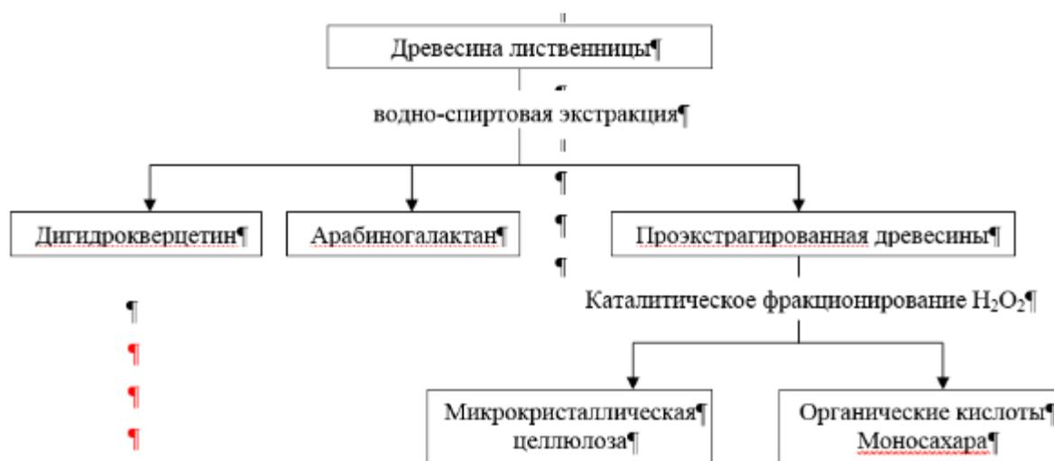
Рис. 2. Биорефайнери древесины лиственницы, основанная на процессе каталитического пероксидного фракционирования
