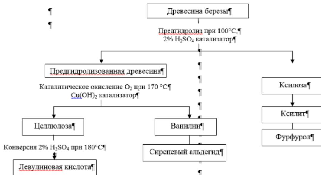
Рис. 1. Биорефайнери древесины березы, основанная на процессе каталитического фракционирования кислородом
